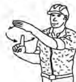
3 Levantar la carga lentamente.
