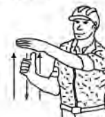
4 Levantar el aguilón o pluma lentamente.
